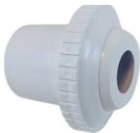
Boquilla de retorno con conexión cementar de 1.5" y salida de 3/4" marca Aquex, fabricada en ABS de alta resistencia.
